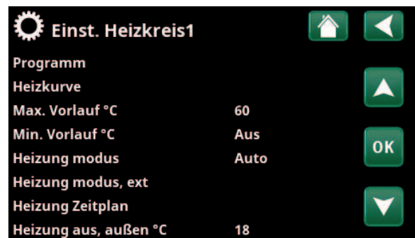
Ausschnitt aus dem Menü „Fachmann/Einstellungen/Heizkreis/Heizkreis 1“.
