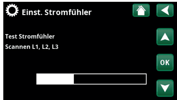
Menü: „Fachmann/Einstellungen/Stromsensoren/Auto-Konfig. Stromsensor“.
