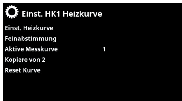
Menü „Fachmann/Einstellungen/Heizkreis/Heizkreis 1/Heizkurve“. Aktive Messkurve: #1.
