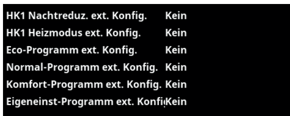
Ausschnitt aus dem Menü „Fachmann/Definieren/Heizkreis“. In den Menüleisten „Programm Eco / Normal / Komfort / Eigene Einstellungen ...“ wird der Normalbetriebs-Modus durch das externe Steuersignal („Schließer (NO)“ oder „Öffner (NC)“) angezeigt.
