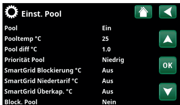
Menü: „Fachmann/Einstellungen/Pool“ Aktivieren Sie diese Funktion über ein externes Steuersignal oder ein Zeitplan.
