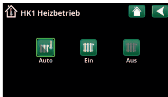
Menü „HC1 Heizung/Kühlung/HC1 Heizbetrieb“, in dem der Modus „Auto“ aktiviert wurde.
