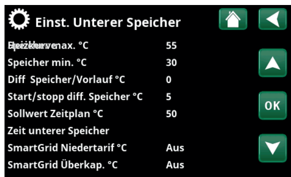
Menü: „Erweitert/Einstellungen/Unterer Speicher“.
