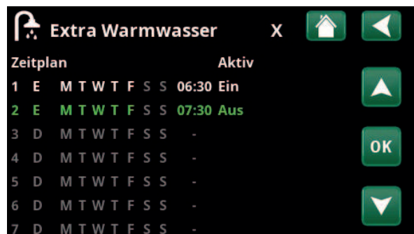
Die Funktion „Extra WW“ ist wochentags von 06:30 bis 07:30 aktiv. Klicken Sie auf das DHW-Symbol, um eine Vorschau unten zu sehen.
