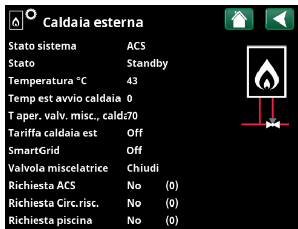
Menù "Dati funzionamento/Caldaia esterna".
