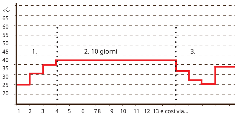
Esempio di modalità 2 con valore impostato "Temper. periodo asciugatura °C": 37.
