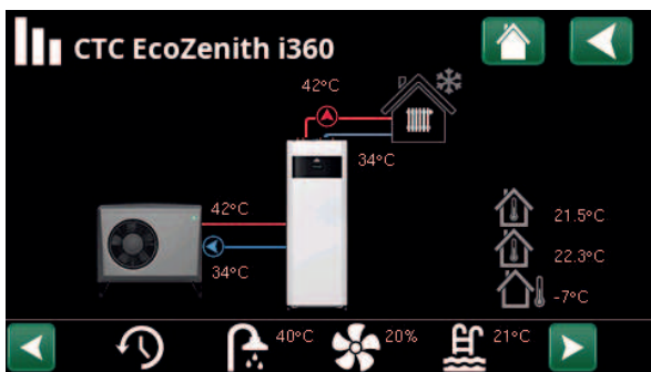
La schermata mostra i dati funzionamento con il CTC EcoAir collegato. Quando le pompe sono in funzione, anche le icone della pompa ruotano sullo schermo.
