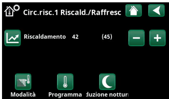
Menu "Avanzato/Definire/Circuito riscaldamento/Circuito riscaldamento 1". Il circuito di riscaldamento non dispone di un sensore ambientale. Il setpoint (temperatura di mandata 45 °C) è indicato tra parentesi, la temperatura di mandata attuale 42 °C è indicata a sinistra del setpoint.
