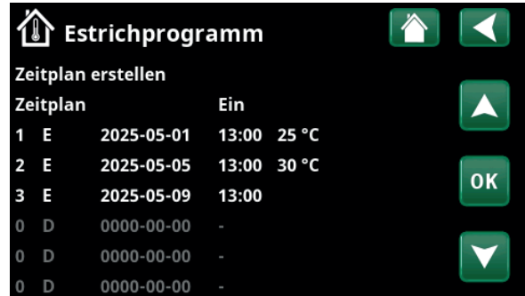
Menü „Fachmann/Einstellungen/Heizkreis/Heizkreis 1/ Estrichprogramm“.
