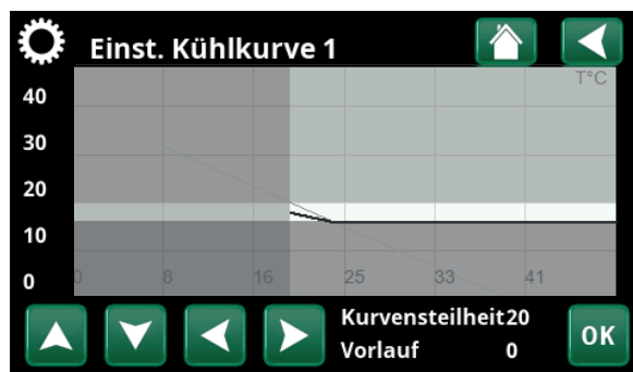
Menü „Fachmann/Einstellungen/Kühlung/Kühlkurve/Einst. Kühlkurve“.
