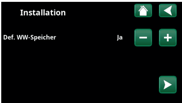
5. Legen Sie mit den Schaltflächen den WW-Speicher fest: Für „Ja“ drücken Sie plus (+). Für „Nein“ drücken Sie minus (-). Bestätigen Sie die Auswahl mit dem Pfeil nach rechts.
