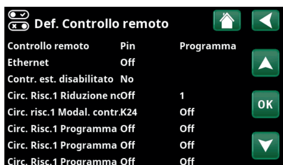
Parte del menù "Installatore/Definire/Controllo remoto".
