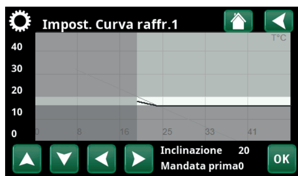
Menù "Installatore/Impostazioni/Raffreddamento/Curva raffreddamento/Impost. Curva raffreddamento".
