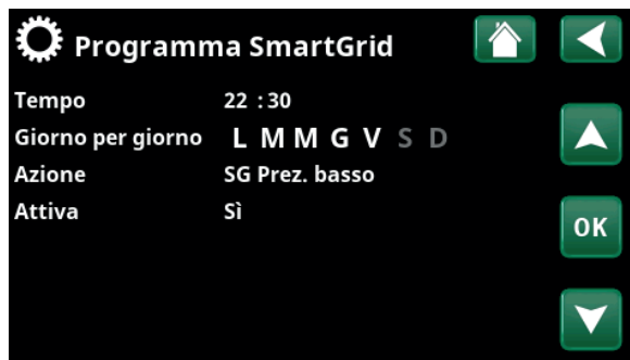
La funzione SmartGrid "SG Prezzo basso" è programmata nei giorni feriali dalle 22:30 alle 06:00. Andare al menù selezionando "Programma SmartGrid" nel menù "Installatore/Impostazioni".
