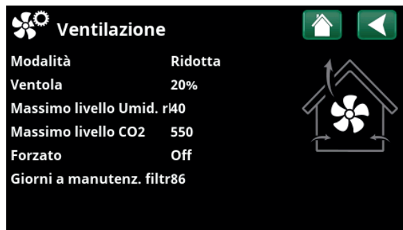
Menù: "Dati funzionamento/Ventilazione".
