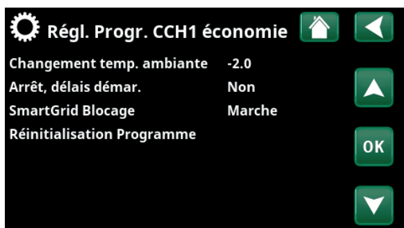
Menu «Avancé/Réglages/Circ Chauffage/Circ Chauffage 1/ Programme/Économie».
