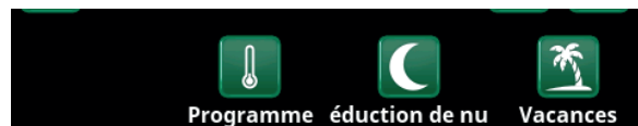
Cliquez sur l'icône «Réduction de nuit» dans le menu «Chauffage/Rafräichissement» du circuit de chauffage pour paramétrer le schéma.
