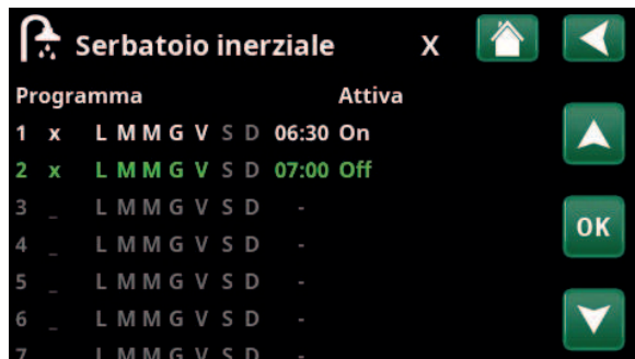
Nell'esempio, il riscaldamento del serbatoio inerziale viene attivato ogni settimana, da lunedì a venerdì dalle 06:30 alle 07:00.
