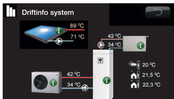
Bilden visar driftinformation med värmepumpen CTC EcoAir ansluten.
