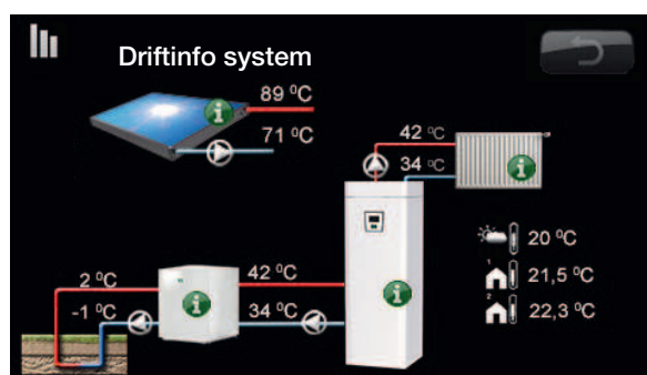
Bilden visar driftinformation med värmepumpen CTC EcoPart ansluten.
